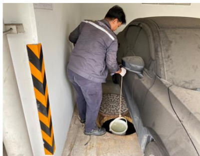
ภาพที่ 3-4 การเก็บตัวอย่างน้ำทิ้ง
